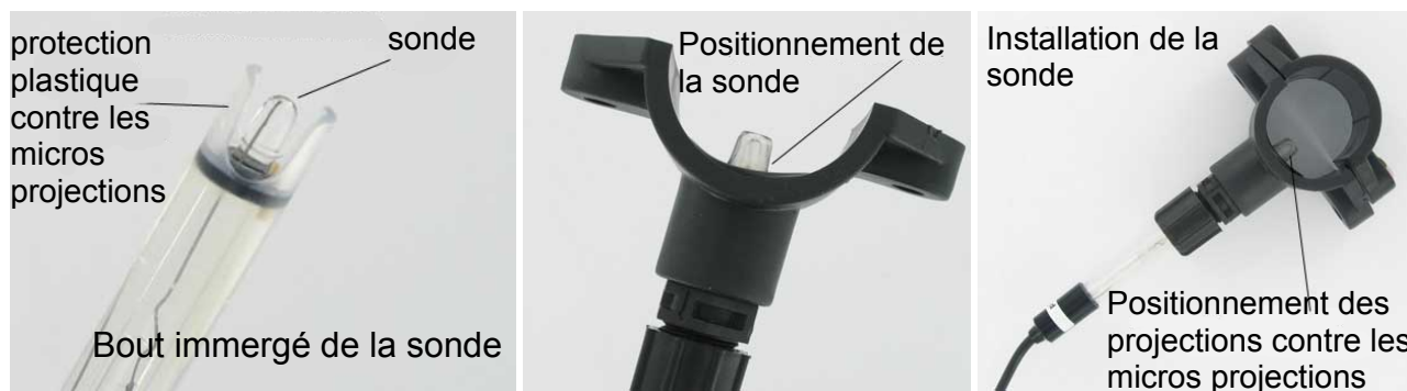
Figure 3 : montage de la sonde pH.
