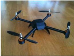
Un châssis « Tenon mortaise »
