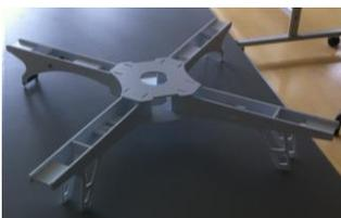
Après la construction d'un premier prototype, la partie électronique venait finalement intervenir avec la partie mécanique, il m'a fallu faire de la place pour deux capteurs ainsi qu'un bus de connexion. Pour cela, j'ai ajouté plusieurs étages en reprenant les plaques déjà conçues.
