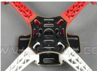
Pour le centre du robot, je me suis inspiré d'un drone trouvé sur internet. En effet, j'ai opté pour une structure à deux plaques montées par vis pour relier les quatre bras.
